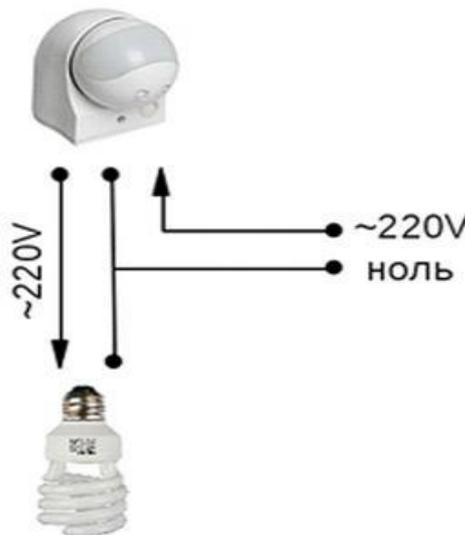
Рисунок схема подключения датчика движения
